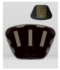
El **Taco RM** se fabrica con pastillas diamantadas metálicas encastadas en el cuerpo de diamante resina. Específico pavimentos hidráulicos (tipo Nolla) donde es necesario un desbaste menos agresivo que el proporcionado por los segmentos totalmente metálicos, evitando así que se desportillen los cantos de las piezas. Tambien puede ser usado en mármol, terrazo y granito
