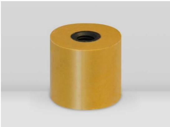
Cilindros diamantados con fijación por rosca M-14 al eje de la amoladora manual con conducto de agua interno. Se emplea para el pulido de cantos interiores y convexos en encimeras de mármol y granito.
