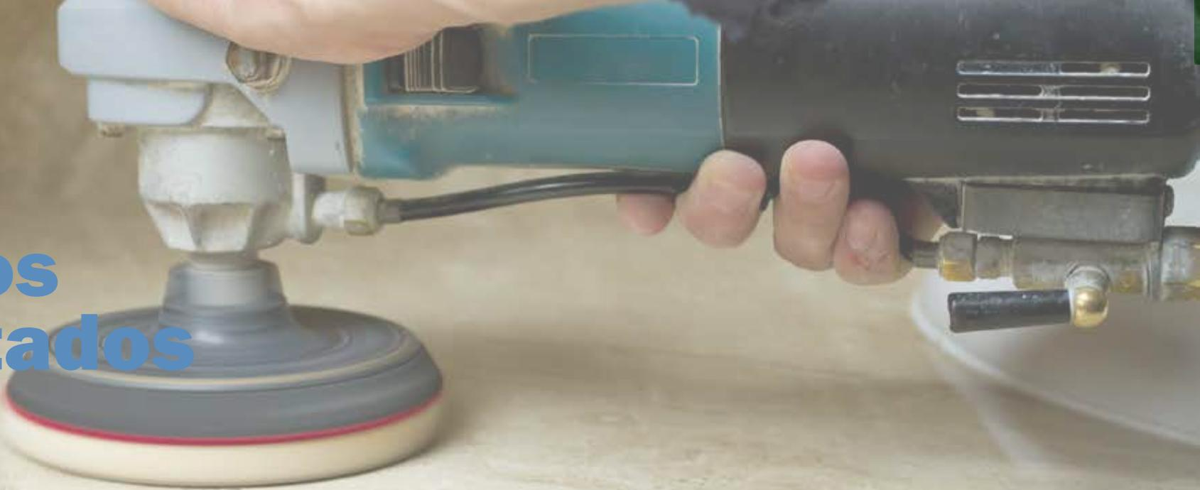
Los diferentes tipos de segmentos de diamante y pads son capaces de desbastar y pulir las superficies a tratar, eliminando los arañazos y dejando la superficie completamente lisa y lista para el tratamiento químico, que es el paso final en el proceso de restauración.
